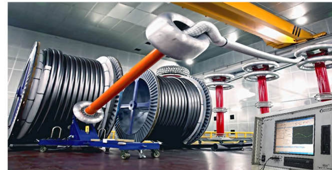
AC. High Voltage Routine Test in factory Thử nghiệm điện áp xoay chiều thường xuyên trước khi xuất xưởng tại nhà máy
